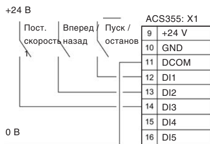
Конфигурация цифровых входов (DI) (подключение PNP) с внешним источником питания (источник)
