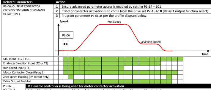
(OUTPUT CONTACTOR **CLOSING** TIME/RUN COMMAND **DELAY TIME)**
